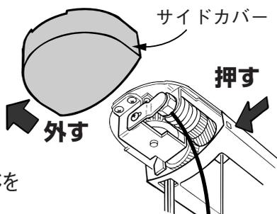
2. 金属プレートのねじをゆるめて下ろす。
